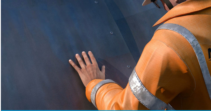
اختبار الترطيب باللمس
